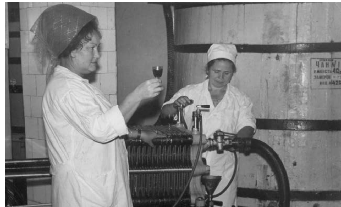
Один из этапов контроля продукции завода — фильтрация купажа
